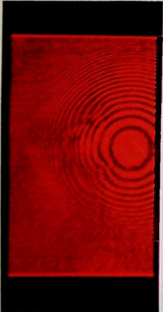
Afb. 8. Hologramen met hun reconstructies, gemaakt met een elektronisch referentie signaal.
